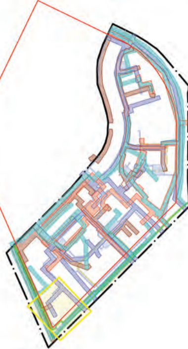
Схема границ охранных зон инженерных сетей М 1:4000
